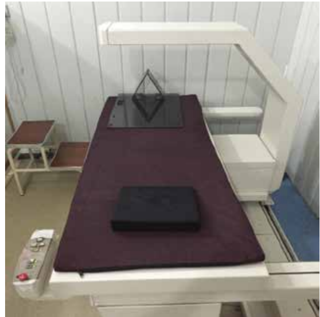
Şekil 1. Kemik metabolizma laboratuvarı: HOLOGIC QDR-4500 kemik mineral yoğunluğu değerlendirme cihazı
